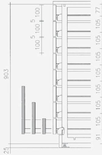
Höhenteilung 125 für 7 Rollauszüge der Nutzhöhe 118 mm · Height unit 125 for 7 roller drawers with useful height 118 mm
