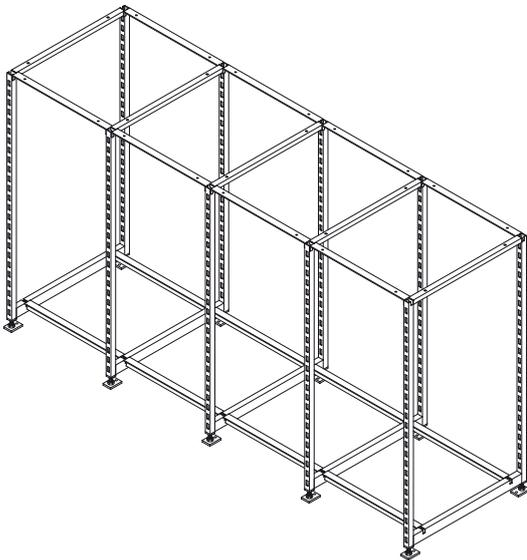
Höhenteilung 105 für 8 Rollauszüge der Nutzhöhe 98 mm · Height unit 105 for 8 roller drawers with useful height 98 mm
