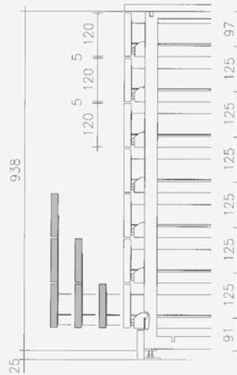
Höhenteilung 140 für 6 Rollauszüge der Nutzhöhe 133 mm · Height unit 140 for 6 roller drawers with useful height 133 mm
