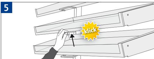
Das hörbare Aus- und Einrasten der Fachböden durch Herunterdrücken des Griffs erlaubt eine stets sichere und bequeme Bedienbarkeit des Systems. Wir empfehlen beim Entriegeln und Herausziehen des Fachbodens in Kopfhöhe die Front mit der anderen Hand zusätzlich abzustützen.
